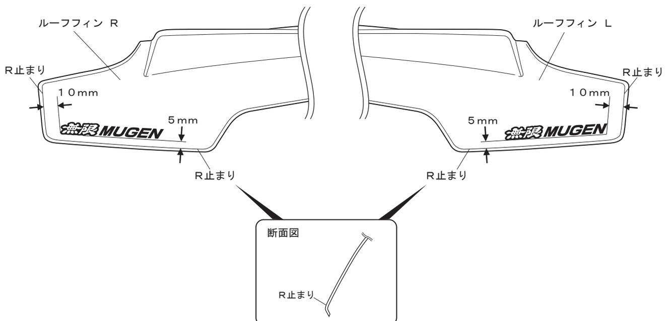
②ルーフィンを車両に仮当てし、下図のように取り付け位置を計測してマスキングテープで取り付け位置をマーキングする。
