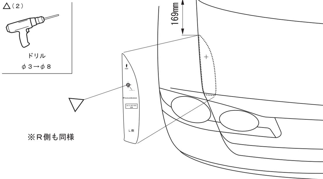
② 下図斜線部をイソプロピルアルコールで脱脂洗浄する。
