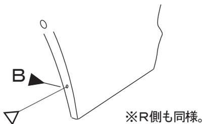
⑩リア アンダー スポイラーの両面テープの離型紙を50mm程剥がし、表に折り返してマスキングテープで固定する。
