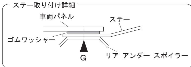
②各ボルト類を本締めし、取付けが完全か確認する。
