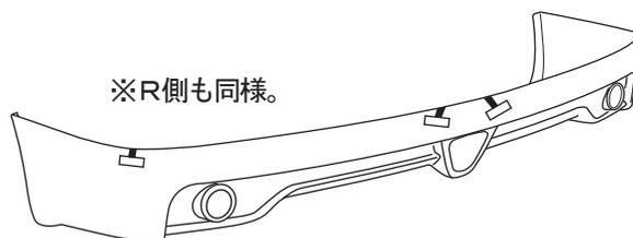
⑪リア バンパーの下図斜線部を脱脂洗浄する。
