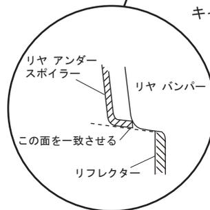
③離型紙を矢印の方向に引き抜き、両面テープを圧着する。
