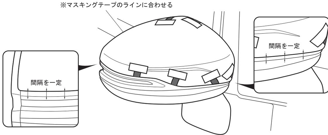
⑤ 離型紙を矢印の方向に下図の順番で引き抜き圧着させる。
