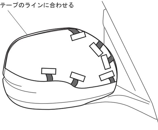
⑤ 離型紙を矢印の方向に下図の順番で引き抜き圧着させる。
