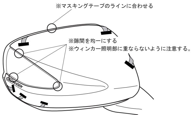
⑥離型紙を→の方向に下図の順番で引き抜き圧着させる。
