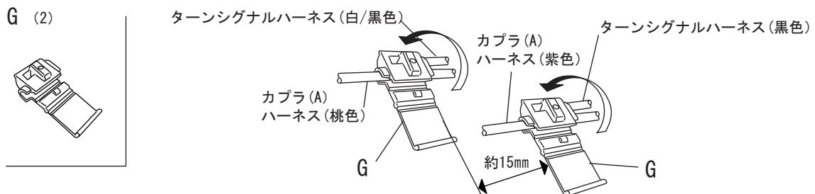
⑪接続したスナップロックコネクタ(G)の上からクッションテープ(H)を二つ折りにしてスナップロックコネクタが全て覆うように貼付ける。
