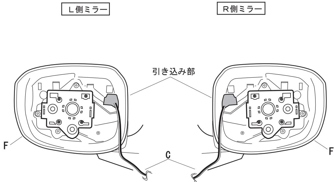
⑨②にて取外したミラー ホルダと逆の手順でハイドロフィック LEDミラー(B)を取付ける。(サービススマニュアル参照)
