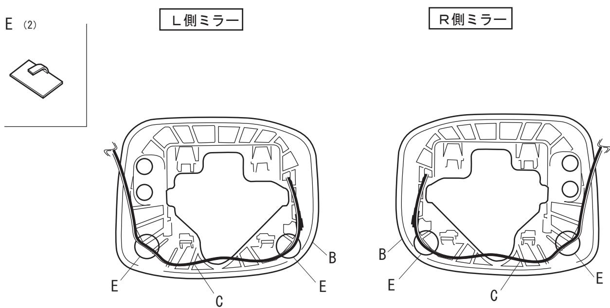
⑧ハイドロフィックLEDミラー(B)のハーネスに装着したターンシグナルハーネス(C)の逆側をパワーミラー(F)の下図の部分から内部に引き込む。
