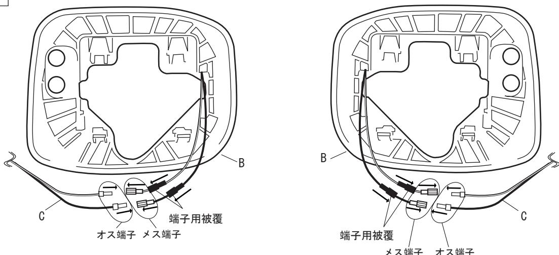
⑦下図のようにターンシグナルハーネス(C)を、付属のコードクリップ2箇所(E)を使って、ハイドロフィックLEDミラー(B)に固定する。
