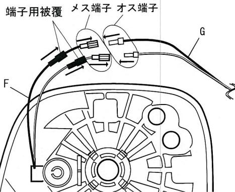
⑨下図のように付属のコードクリップ(H)を用いて電線を2箇所固定する。
