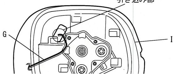
⑪②にて取外したミラー ホルダと逆の手順でハイドロフィリックLEDミラー(F)を取り付ける。(サービスマニュアル参照)
