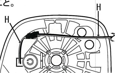
⑩ハイドロフィリックLEDミラー(F)のハーネスに装着したターンシグナルハーネス(G)の逆側をパワー ミラー(I)の下図の部分から内部に引き込む。
