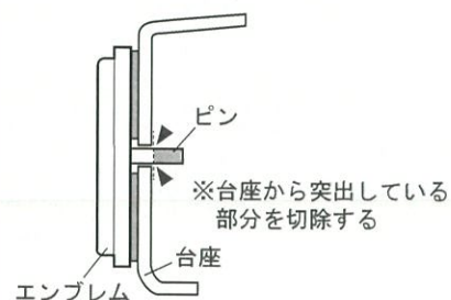
[エンブレム貼り付け部断面図]
