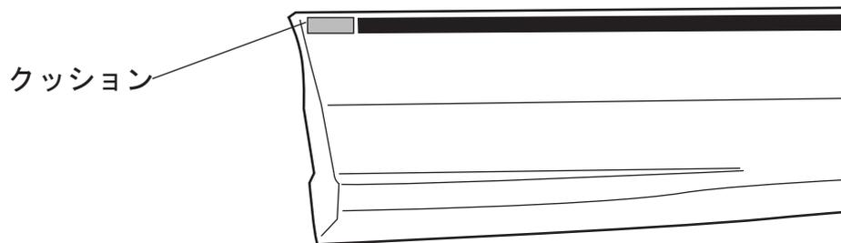
②未塗装品は塗装後に、フロント フェンダ パネル、フロント パネル、リア パネルにモールを貼り付ける。ただしリア パネル後端の、裏側にクッションが貼られている部分は除く。
