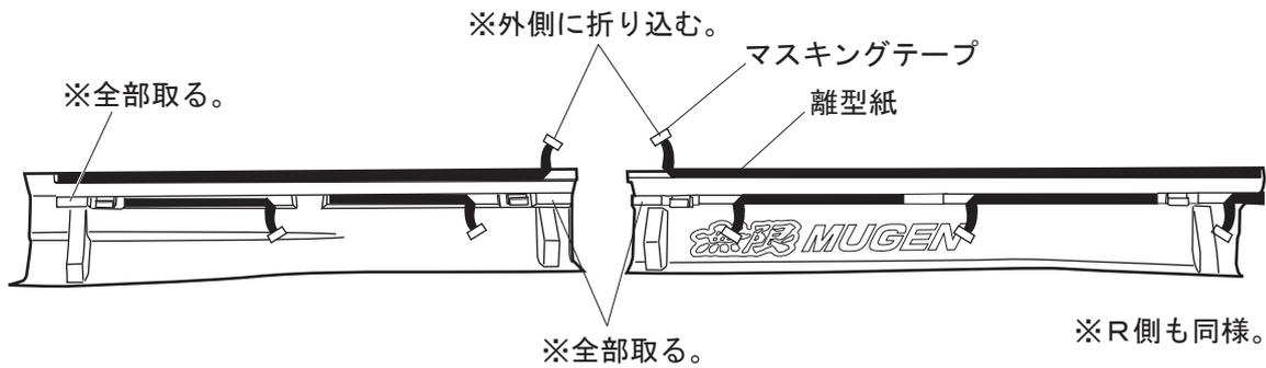
⑥フロント/リヤ インナーパネルを下図の寸法で取り付ける。
