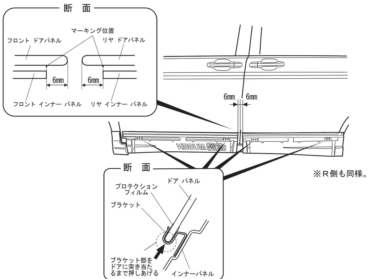
⑦取り付け位置を確認し、離型紙を→の方向に引き抜くように剥がし圧着する。
