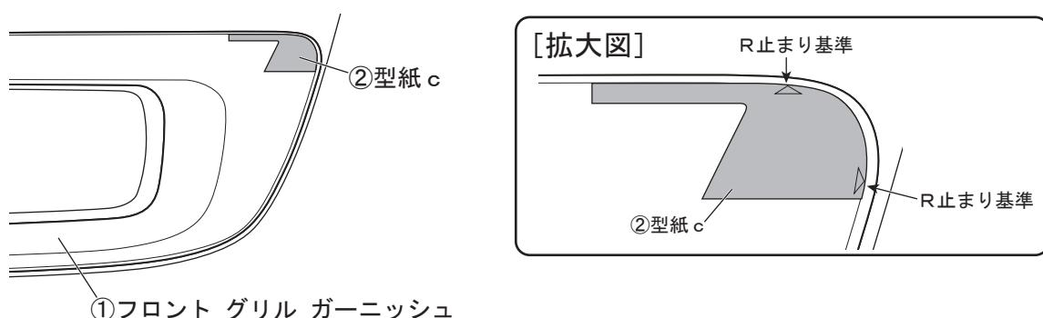
6. ③エンブレムの離型紙を剥がして②型紙cに合わせながら①フロント グリル ガーニッシュに仮あてし、取り付け位置を確認して圧着する。
