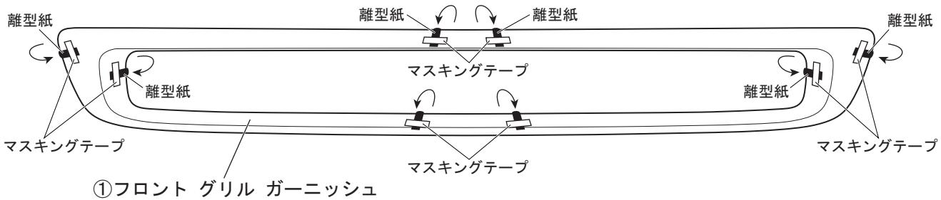
3. ①フロント グリル ガーニッシュを車両に仮あてし、取り付け高さマーキングおよび②型紙b (R/L) に合わせながら取り付け位置を確認し、両面テープの離型紙を矢印の方向に下記順番で引き抜く様に剥がし圧着する。
