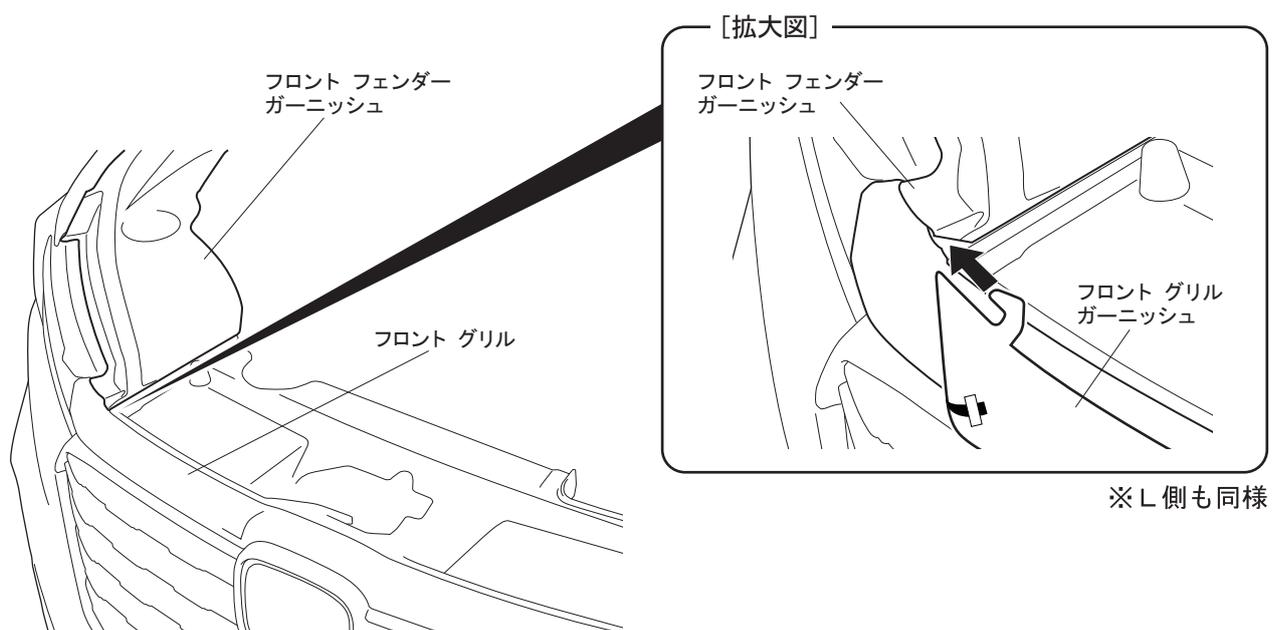
4. フロント グリル ガーニッシュの取り付け位置を確認し、両面テープの離型紙を矢印の方向に下記順番で引き抜く様に剥がし圧着する。
