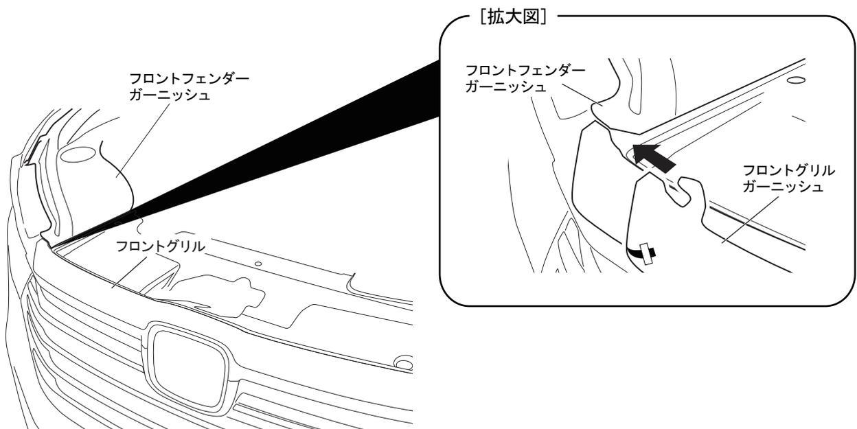
④フロント グリルガーニッシュの取付け位置を確認し、下図の順番に従い、両面テープの離型紙を引き抜くように剥がして中心から外側に向かって圧着する。
