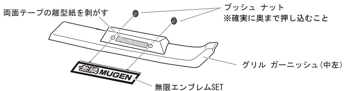
②車両フロント グリル の下図斜線部を脱脂洗浄する。
