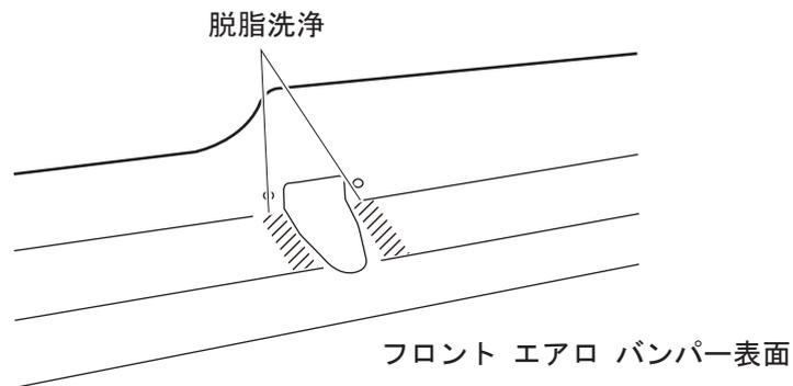
④カメラ カバーをフロント エアロ バンパーの穴位置に合わせ仮止めする。
