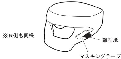
③フロント エアロ バンパーの下図斜線部を脱脂洗浄する。
