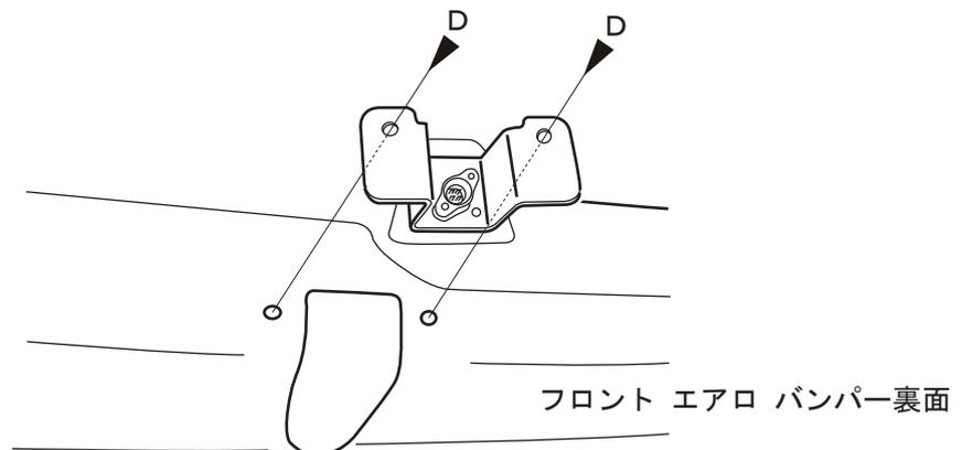
⑥カメラ カバーの離型紙を矢印の方向に剥がし、圧着する。
