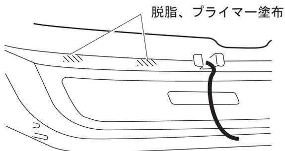
⑨配線用ブラケットを図示位置に貼り、カメラのハーネスを固定する。
