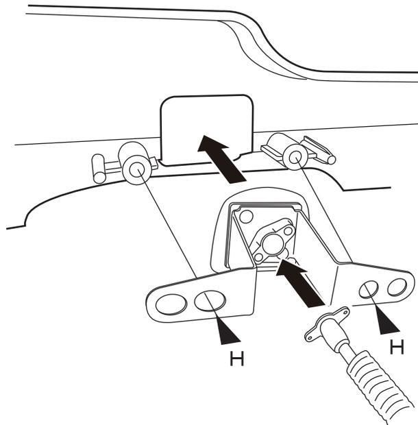
⑯スポーツグリルをバンパーに戻し、バンパーを車両に取付ける。このときカメラハーネスのカプラーを接続する。(サービスマニュアル参照)
