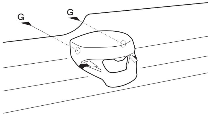
⑬カメラカバーの離型紙を矢印の方向に剥がし、圧着し本締めする。
