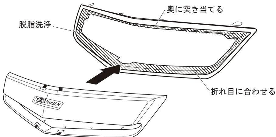
⑩ 離型紙を矢印の方向に引き抜き、圧着する。
