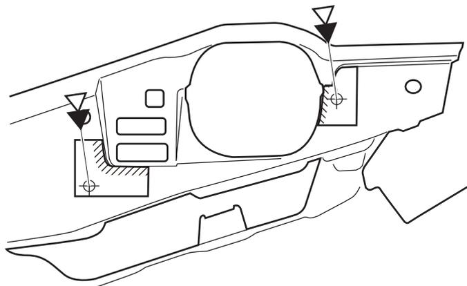
⑤フロント バンパー開口部の突起部分(下図斜線部)を脱脂し、クッションを貼り付ける。
