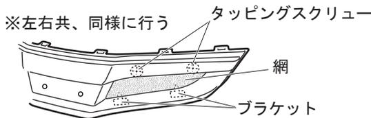
※網の端末で手を切る恐れがありますので、必ず保護具を着用し、注意して作業を行ってください。
