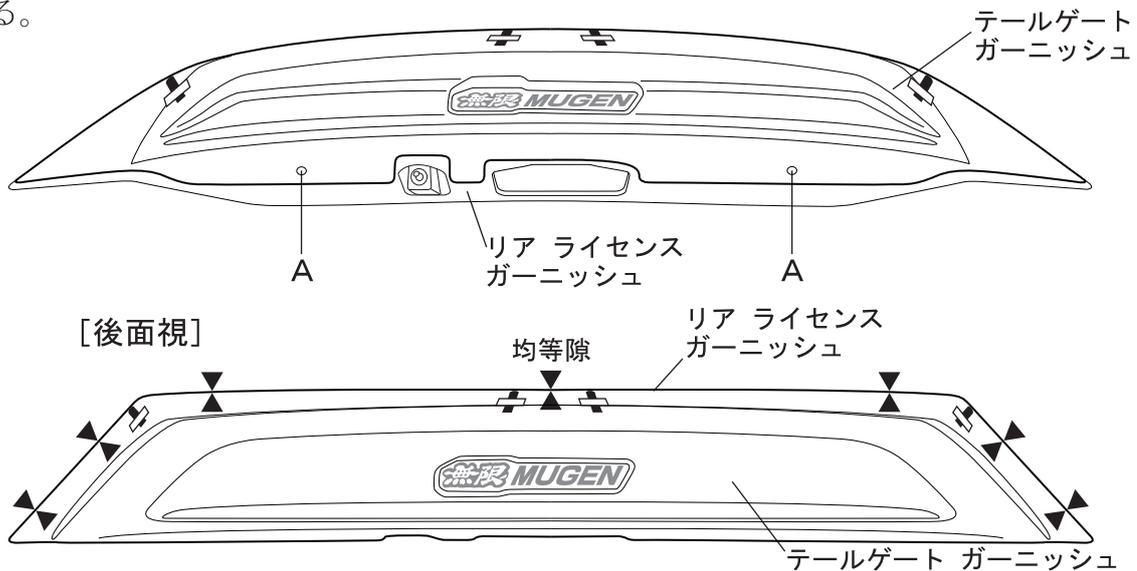
③取り付け位置および各部の隙を確認し、両面テープの離型紙を矢印の方向に下記順番で引き抜く様に剥がし圧着する。
