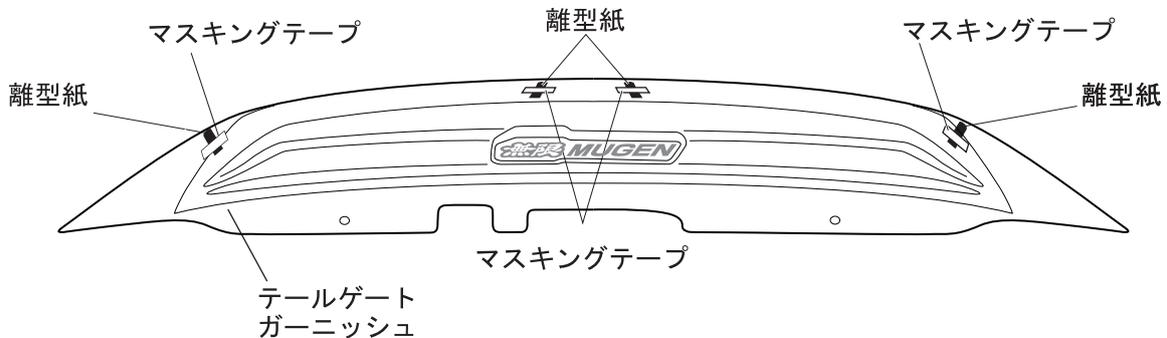
②テールゲート ガーニッシュをリア ライセンス ガーニッシュに仮あてし、形状に合わせて押し当てながら周囲の隙が均等になるよう位置決めし、下面をクリップ (A) で2ヶ所固定する。
