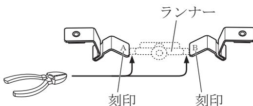
⑤ 下記要領にて、全てのブラケットをドアパネルに取り付ける。その後ガラスランを元に戻し、ベンチレーテッドバイザー取り付け穴と位置を確認し、ブラケット位置を調整する。
