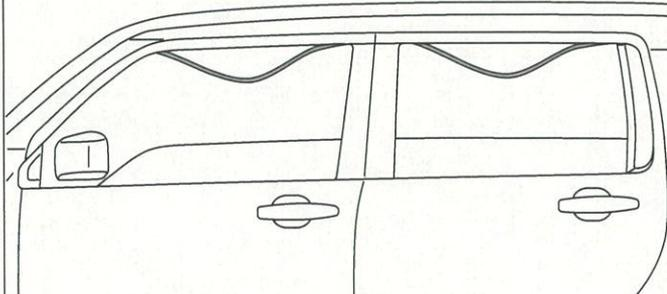
③ ドアパネルの両面テープ接着面を、イソプロピルアルコールで脱脂洗浄する。
