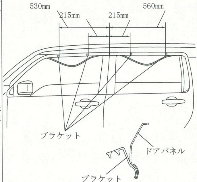
⑥ 下図要領にて、両面テープの離型紙端末にマスキングテープでピクテープを作成する。
