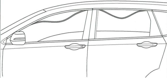
③ ドアパネルの両面テープ接着面を、イソプロピルアルコールで脱脂洗浄する。
