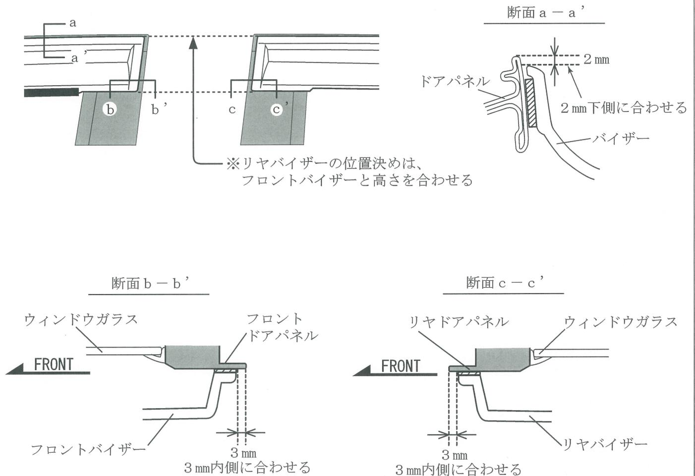
④ 取り付け位置を確認しながらフロント、リヤバイザーの両面テープの離型紙を矢印の方向に引き抜くように剥がし、圧着する。
