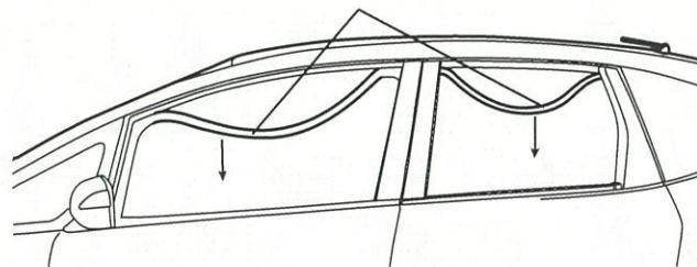
③ ドアパネルの両面テープ接着面を、イソプロピルアルコールで脱脂洗浄する。
