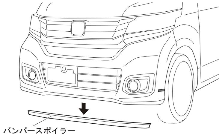
④型紙を使用し、フロントバンパーに穴位置をキリでマーキングし、更にカットラインを水性ペンでマーキングする。
