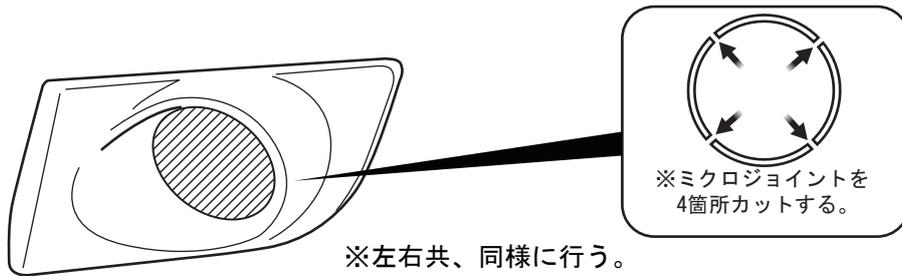
③フロント アンダー スポイラーの両面テープの離型紙を剥がし、外側に折り曲げマスキングテープで固定する。
