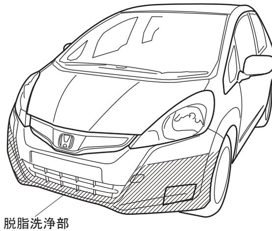
②下図斜線部に脱脂洗浄後ブラックアウトフィルムをシワにならないように貼る。
