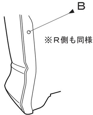
③フロント アンダー スポイラをB、Dを使って仮付けし、ブラケットの穴位置で4箇所とホイールアーチの穴位置で2箇所水性ペンでケガキをいれる。
