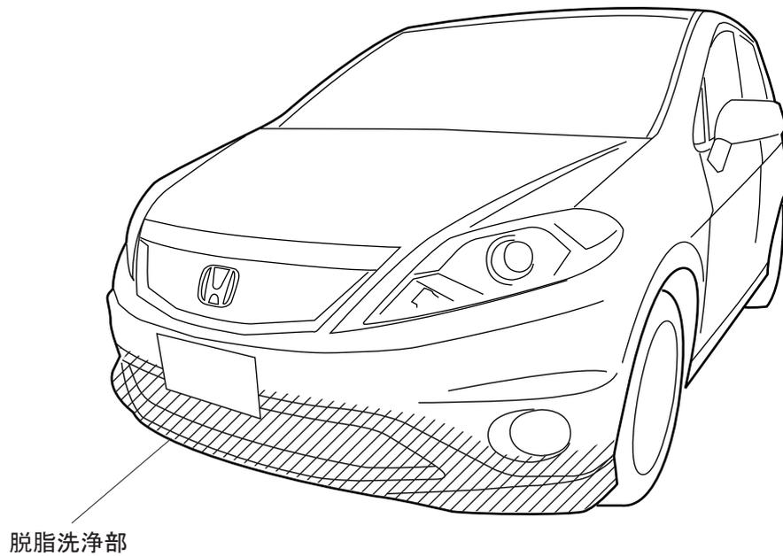
②フロント アンダー スポイラの両面テープの離型紙を50mmほど剥がし、外側に折り曲げマスキングテープで固定する。
