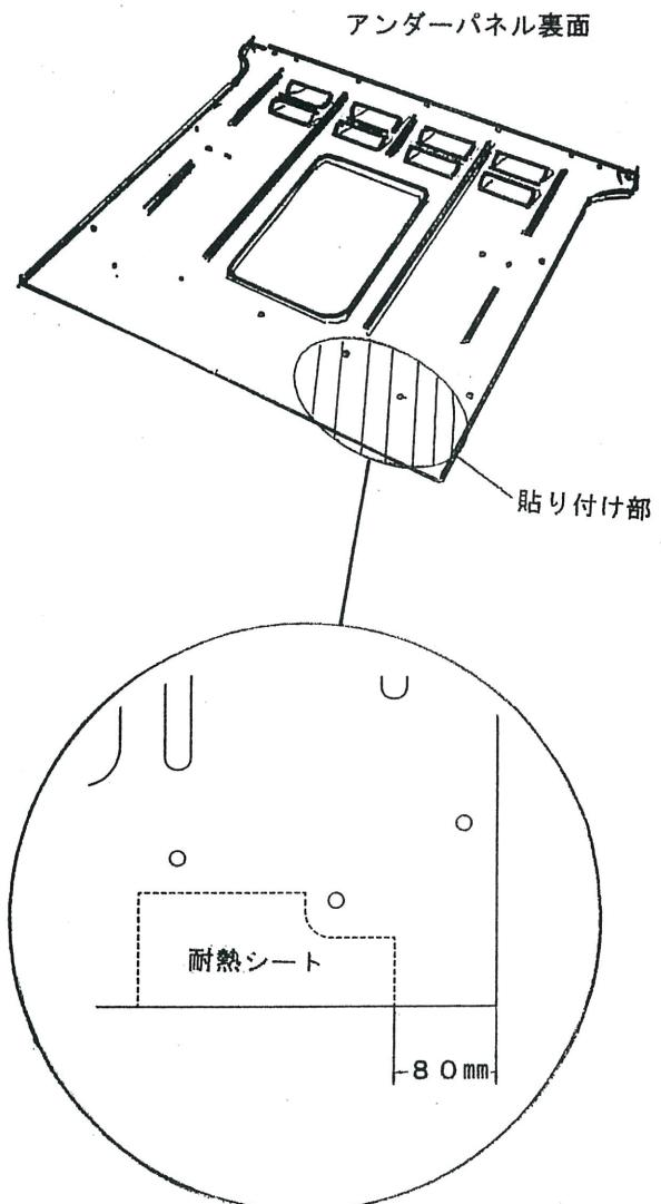
②アンダーパネルをクリップA・B、バンパーボルトで取り付ける。
