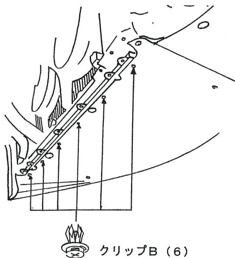
⑱ハーフバンパーが適切な位置にきているかを確認し、両面テープの離型紙を引き抜くように剥がし、バンパーに押し付ける。
