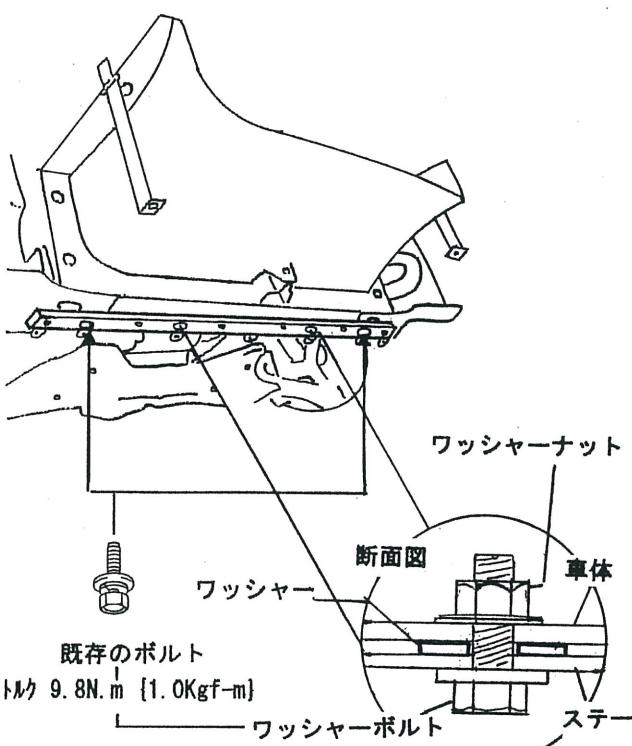
⑥アンダーステーにクリップナットを差し込む。
