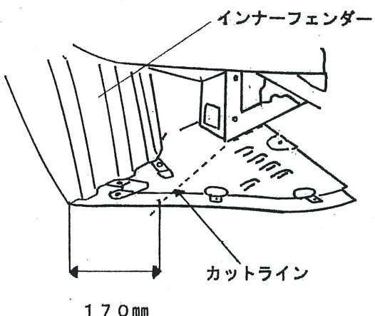
④インナーフェンダーの下図のスリット穴2個所に、クリップナットを差し込む。(左右同様に行う)
