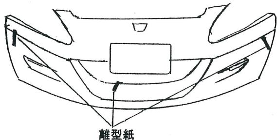
⑭フロントバンパーを取り外しと逆の手順で車体に取り付ける。（インナーフェンダーの加工とフロントアンダーカバーの取り外しにより、7ヶ所ボルトが不要となります）
