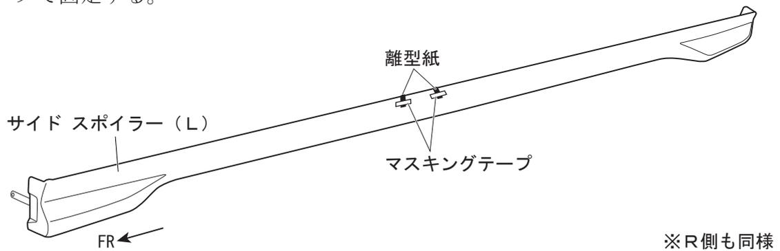
③サイド スポイラーを車両に仮あてし、側面の取り付け高さマーキングに合わせながら下面ブラケット部をトラスボルト (B)、フランジナット (C)、フロント ホイールハウス部を低頭タッピングスクリュー (D)、リア ホイールハウス折り返し部をタッピングスクリュー (E) で仮止めする。
