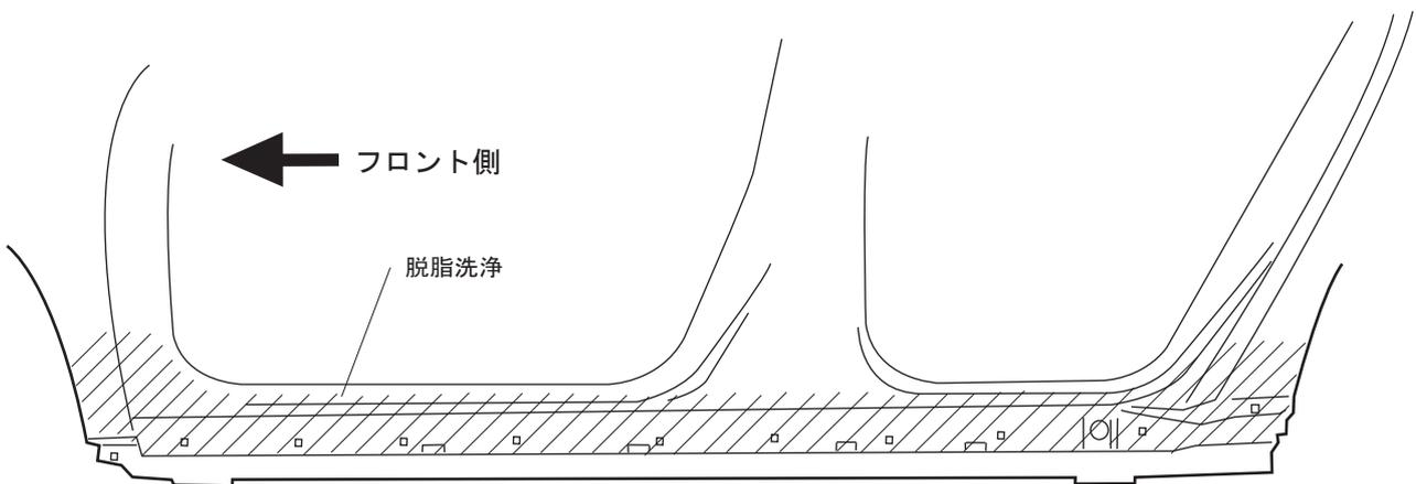
⑤下図のように両面テープの両側の離型紙を30mm程剥がし、マスキングテープで止める。
