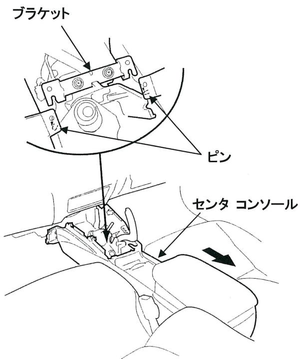
⑨センタ コンソールの後側を持上げ、インストルメントパネルの下から引き出し、取り外す。
