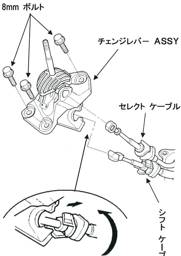
※ケーブル本体を回転させロックをはずし切り欠き部分から抜取る。
