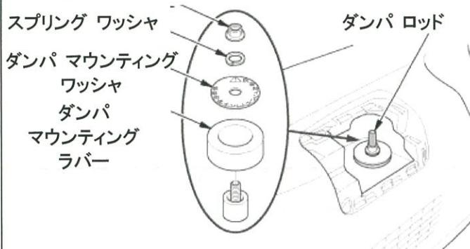
⑤六角レンチでダンパ ロッドを保持して、フランジナットを規定トルクで締付ける。
