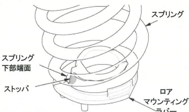
ロアマウンティングラバーの突起部に石鹼水を塗布し、ロアスプリングシートの位置決め穴に合わせて取付ける。
