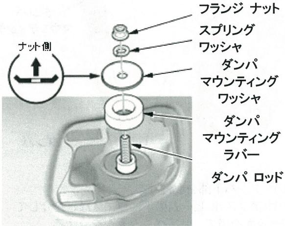
六角レンチでダンパ ロッドを固定してフランジ ナットを規定トルクで締付ける。
