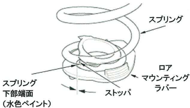
ロア マウンティング ラバーの突起部に石鹼水を塗布し、ロア スプリング シートの位置決め穴に合わせて取付ける。
