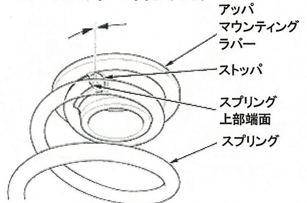
スプリングにロア マウンティング ラバーを取付け、スプリング下部端面をロア マウンティング ラバーのストッパに突き当てる。
