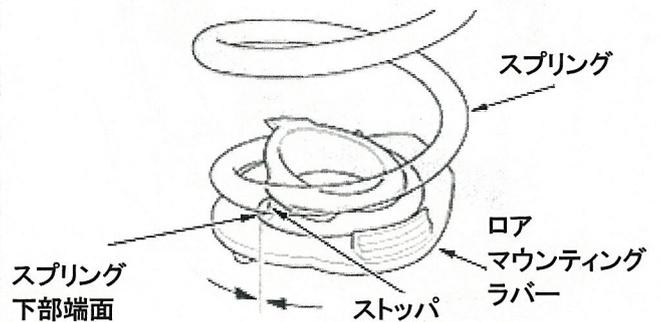
ロア マウンティング ラバーの突起部に石鹼水を塗布しロア スプリング シートの位置決め穴に合わせて取付ける。
