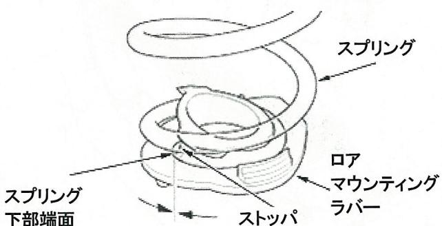
ロア マウンティング ラバーの突起部に石鹼水を塗布しロア スプリング シートの位置決め穴に合わせて取付ける。
