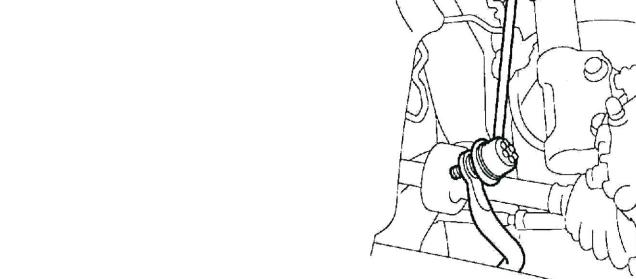
④ロア アームのナックル下部にジャッキを掛けてフロント サスペンションを持ち上げ、車重をかけた状態で取付けボルト、及びナットを規定トルクで締め付ける。
