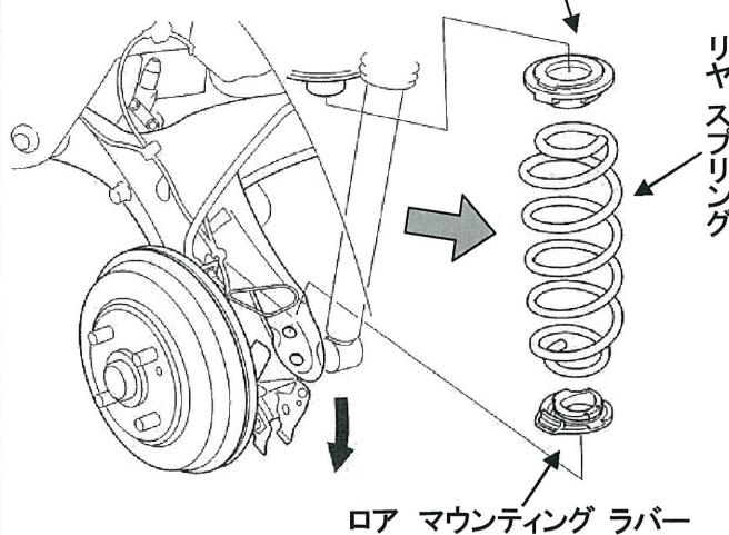
⑥ジャッキを下げ、リヤ アクスル ビームを押し下げてリヤ スプリングとアッパ マウンティング ラバーおよびロア マウンティング ラバーを取り外す。
