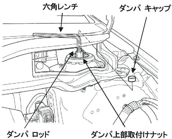
⑩ダンパ上部取付けナットとウェーブ ワッシャを外し、ダンパ マウンティング ベースを取り外す。
