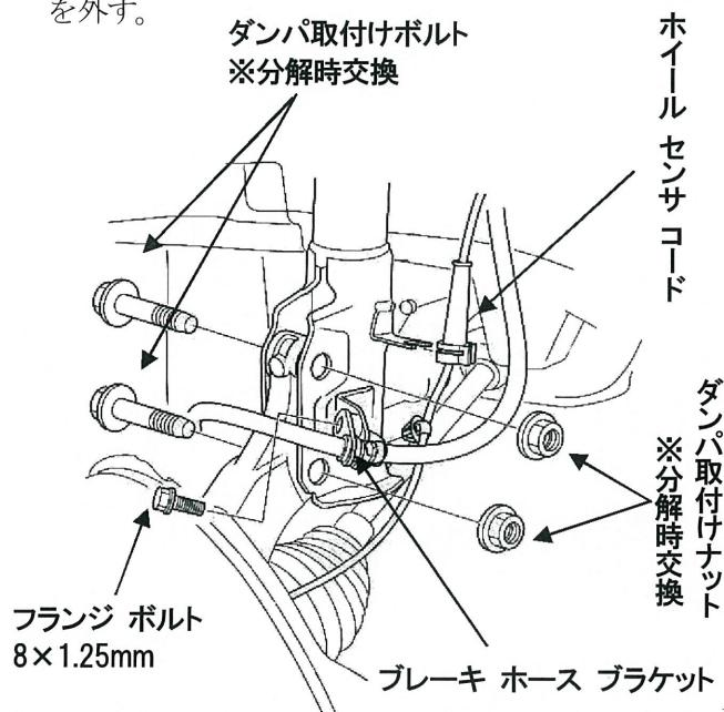
⑤フランジ ボルトを外し、ブレーキ ホース ブラケットをダンパから取外す。
