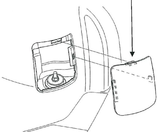
⑧ダンパ上部取付けナット、ダンパマウンティングワッシャ、ダンパマウンティングラバーを取外す。
