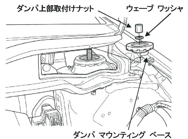
②ダンパ取付けボルト、ブレーキ ホース ブラケットをダンパに仮締めし、ホイール センサ コードをダンパに取付ける。
