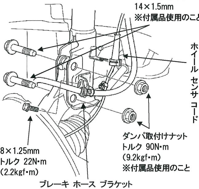
③スタビライザ リンクをダンパに取付け、仮締めする。
