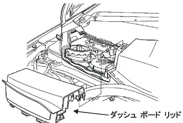
⑨ダンパ キャップを取り外し、六角レンチでダンパ 上部のダンパ ロッドを保持し、ダンパ上部取付けナットを緩める。
