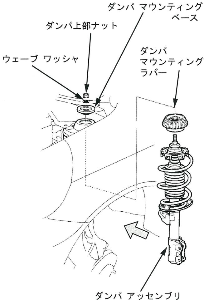
④ダンパ アセンブリをナックルに取付け、付属のダンパ取付けボルトと付属のダンパ取付けナットで仮締めする。
