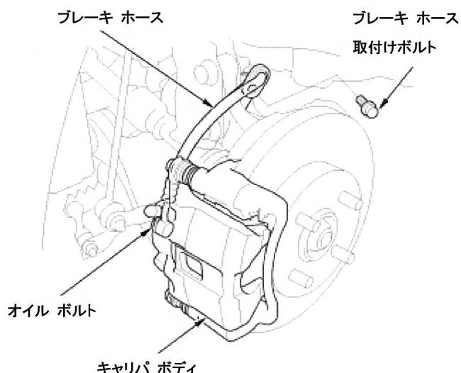
⑤ブレーキ ホース取付けボルトを取り外し、ブレーキ ホースを取り外す。
