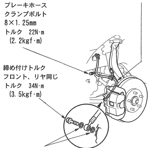
⑦ホース固定クリップをブレーキホースの溝に取り付けて、ホースを固定する。
