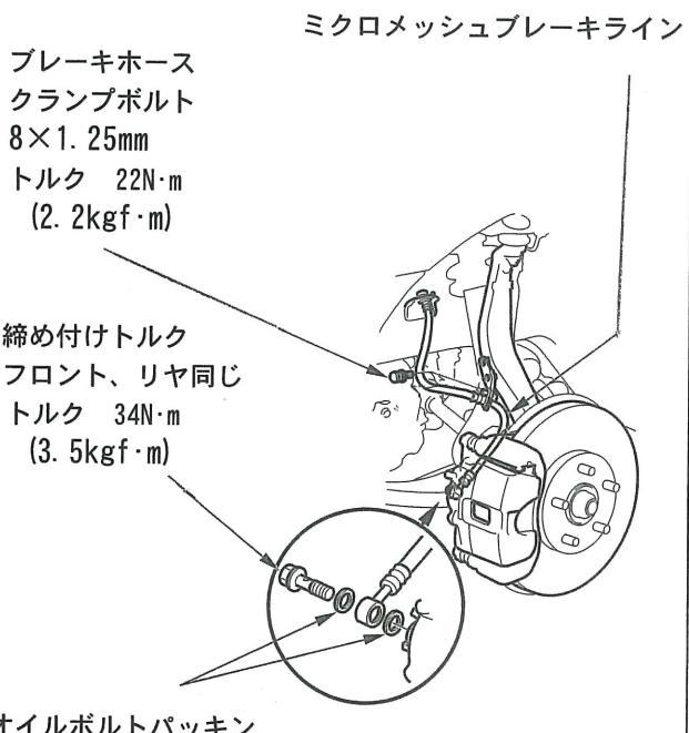
⑦ホース固定クリップをブレーキホースの溝に取り付けて、ホースを固定する。
