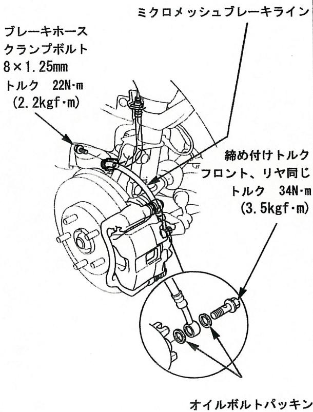
⑦ホース固定クリップをブレーキホースの溝に取り付けて、ホースを固定する。
