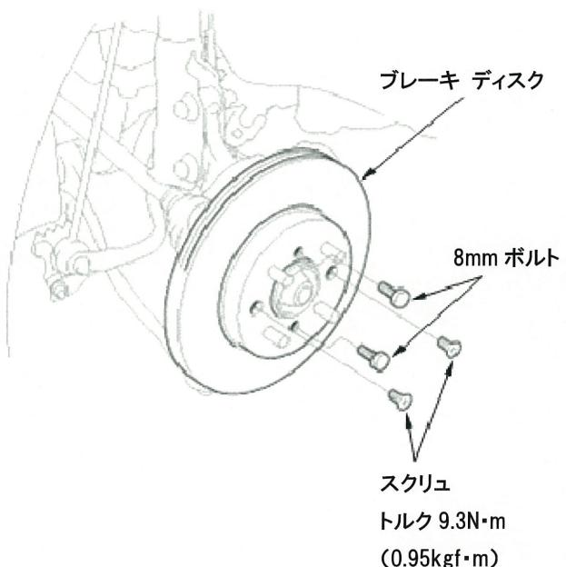
⑥取付けは取外しと逆の手順で行い、ブレーキペダルを踏んでブレーキが作動する事を確認する。
