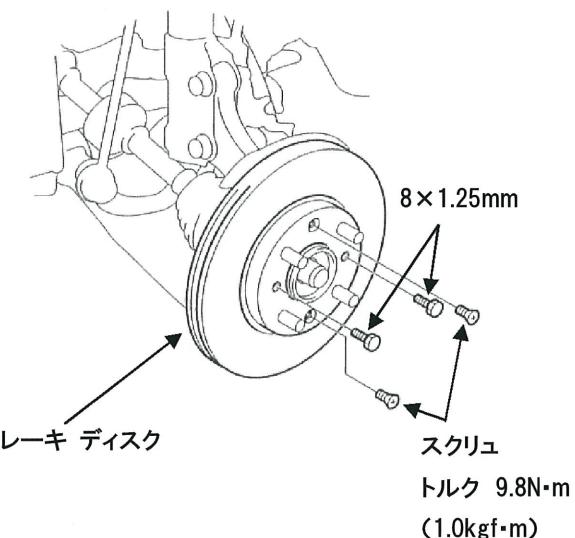
⑥取付けは取外しと逆の手順で行い、ブレーキペダルを踏んでブレーキが作動する事を確認する。
