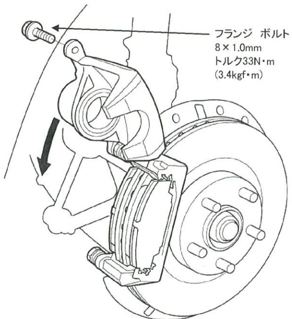
④キャリパ ボディを元の位置に戻し、フランジ ボルトを締付ける。
