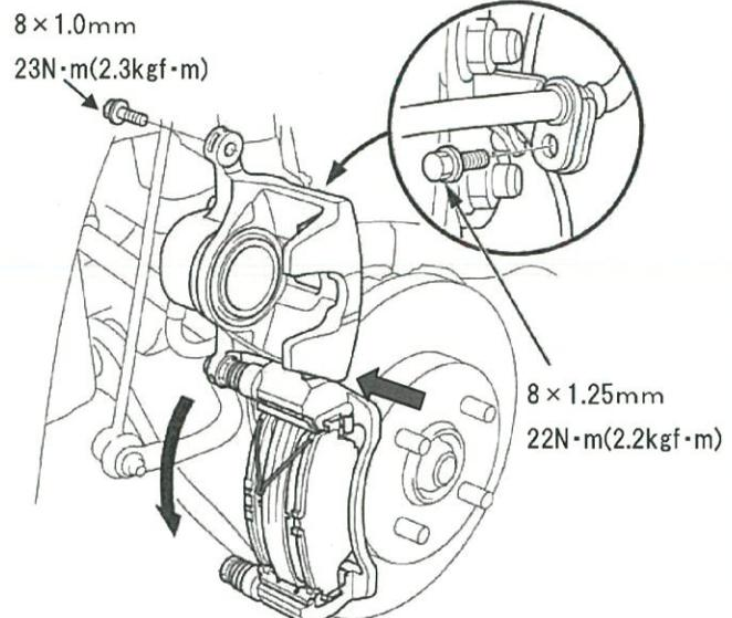
⑥ブレーキ ペダルを数回踏んで、ピストンを押し出しブレーキが効くことを確認する。
