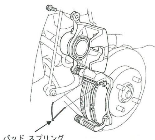
⑤キャリパ ボディを元の位置に戻し、ブレーキ ホース クランプ ボルトと8mmフランジ ボルトを締め付ける。
