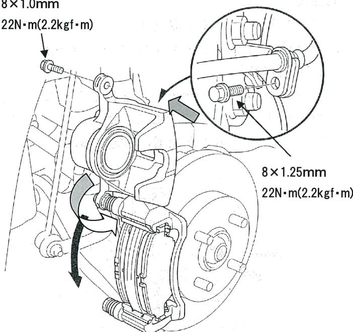
④キャリパーボディを元の位置に戻し、ブレーキホース クランプ ボルトと8mmフランジボルトを締め付ける。
