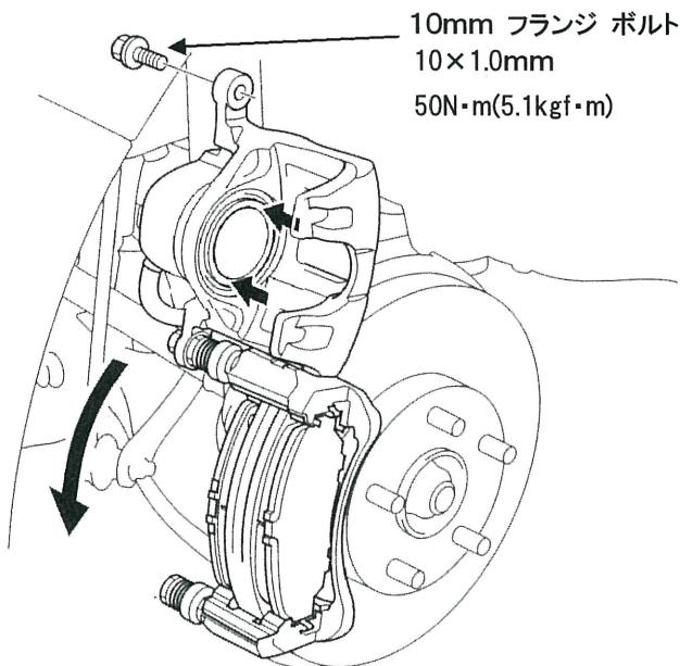
④キャリパ ボディを元の位置に戻し、10 mmフランジ ボルトを規定トルクで締め付ける。
