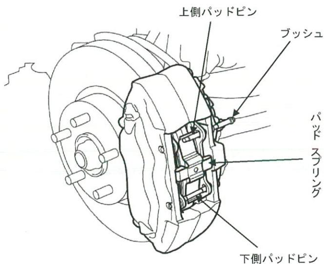
④パッド スプリング下側をパッド ピンに引っ掛けて取付け、パッドを押さえる。
