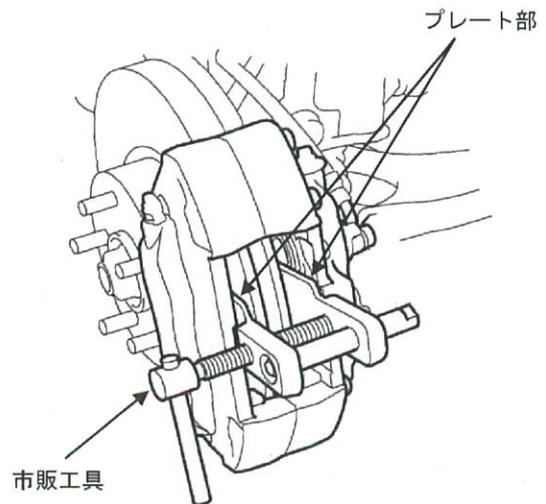
②無限フロント パッドのキャリパ ボディ内側接触部にグリースを塗布しキャリパに取付ける。
