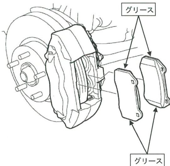
③下側のパッド ピンをキャリパのインナ側からパッドのプレート穴を通して、アウト側へ差し込む。
