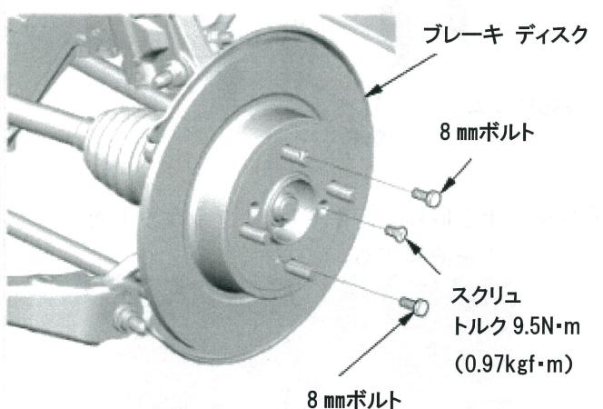
⑨取付けは取外しと逆の手順で行い、ブレーキペダルを踏んでブレーキが作動する事を確認する。
